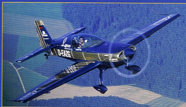
DIE EXTRA 200 , Baujahr 1996, hat eine Rollrate von mehr als 420 Grad pro Sekunde. Das Lastvermögen beträgt +/- 10 g.
